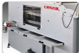
Diseño higiénico. Recolección de desecho en tres bandejas fácilmente extraíbles.
