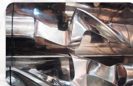
Palas doble Sigma en acero inoxidable pulido.
